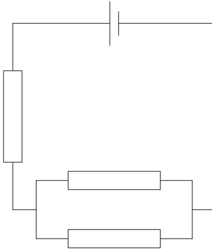
La célula tiene una f.e.m. de  $2,0\text{ V}$  y una resistencia interna despreciable.
