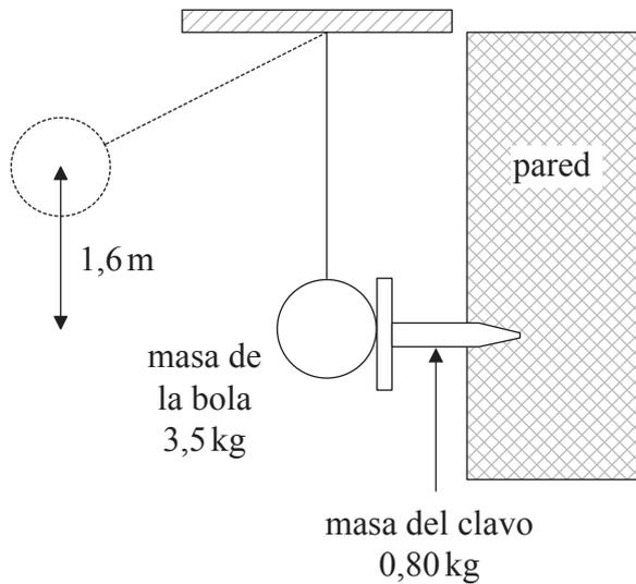
La masa de la bola es de 3,5kg y la masa del clavo es de 0,80kg. Justo después del impacto, la bola y el clavo se mueven juntos. Demuestre que
